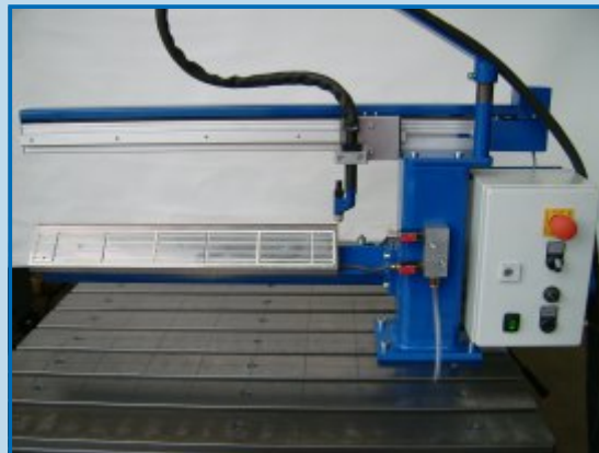
Сварка угловыми швами на вакуумных балках
