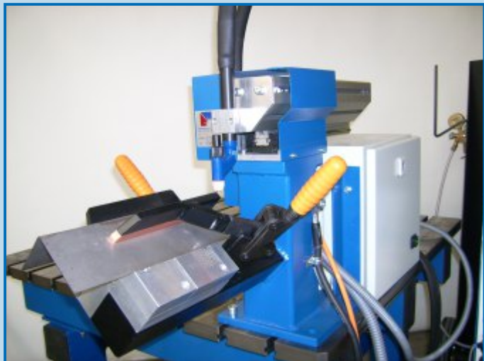
Механическая сварка продольными швами
