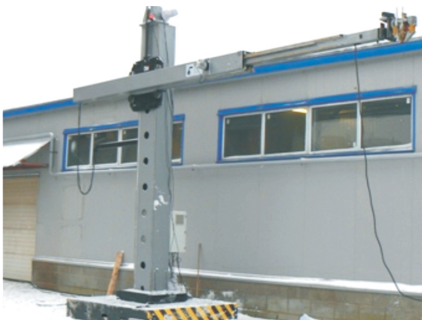
Колонна сварочная легкая серии КС-120 (200) внешний вид
