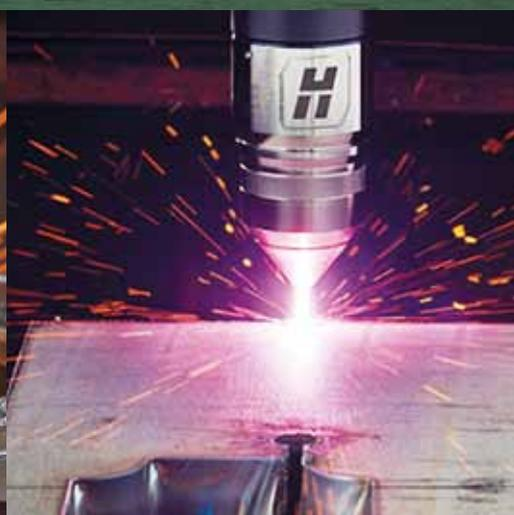
Комплекс термической резки металлов
