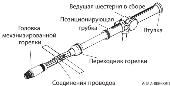
Рисунок 7-7. Сборочный узел горелки
