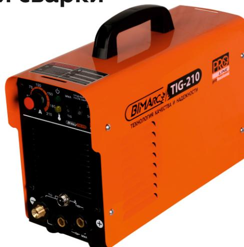
Установка сварочная TIG-210 BIMArc PRO Line предназначена для аргодуговой сварки неплавящимся электродом на постоянном токе всех видов металлов и сплавов (TIG) и для ручной дуговой сварки покрытым электродом (MMA).
