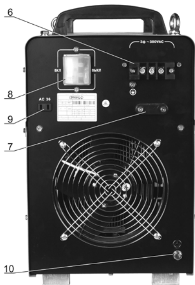
Рисунок 3 – Тыльная панель полуавтоматов сварочных БИМАрк MIG-350/ MIG-500
