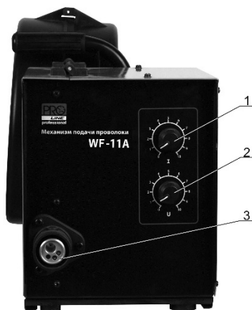
Рисунок 5 – Панель управления полуавтомата БИМАрк MIG-350/ MIG-500
