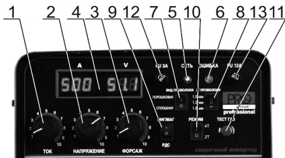
Рисунок 4 – Панель управления источника БИМАрк MIG-350/ MIG-500
