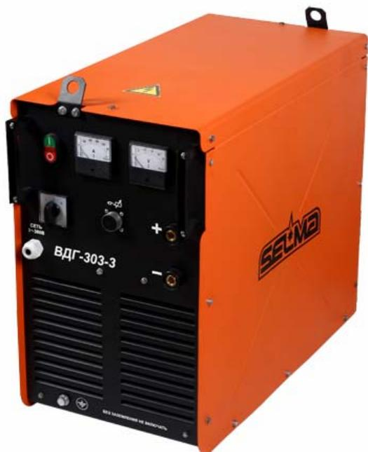
Выпрямитель сварочный ВДГ-303-3 предназначен для комплектации полуавтоматов дуговой сварки.
