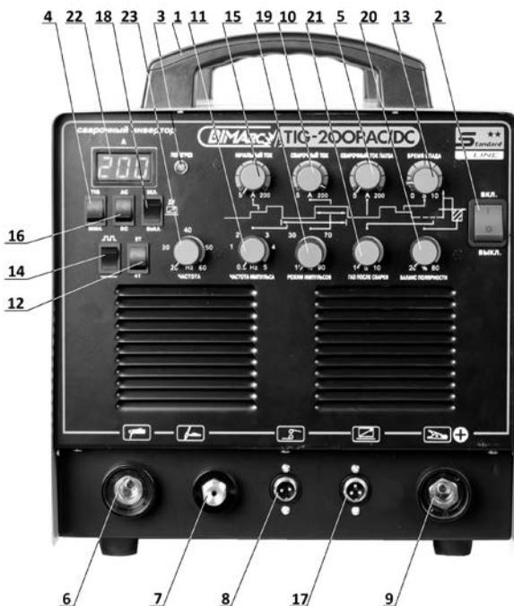
Рисунок 2 – Лицевая панель установки TIG-200P AC/DC BIMArc Standard Line
