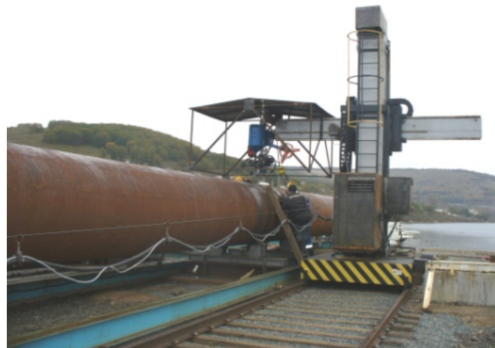
Сварочная колонна 3х3
