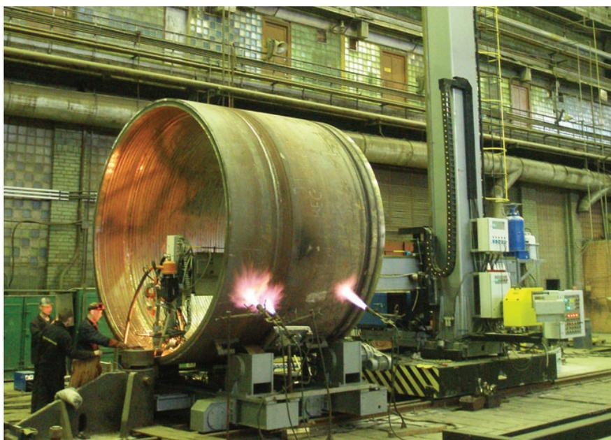
Колонна сварочная супер тяжелая серии КС-800 внешний вид
