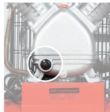
1 – маслозаливное отверстие 2 – масляный сапун
